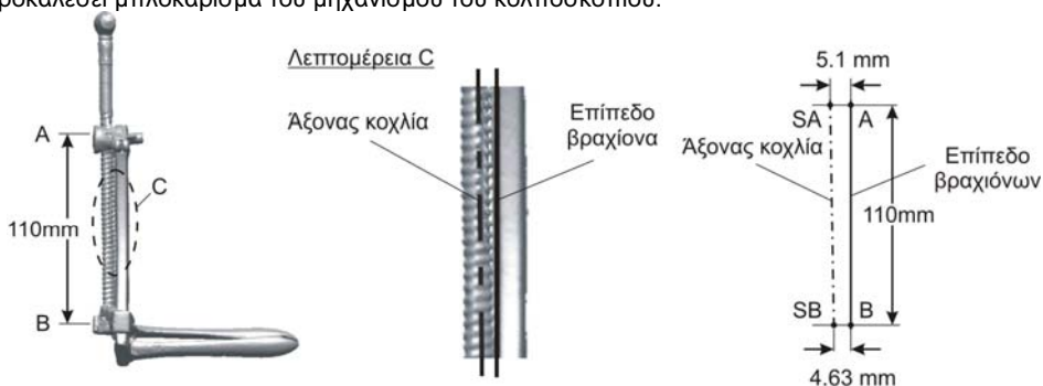
Σχήμα 17: Παραλληλότητα του άξονα του κοχλία σε σχέση με τις επίπεδες επιφάνειες των βραχιόνων.
