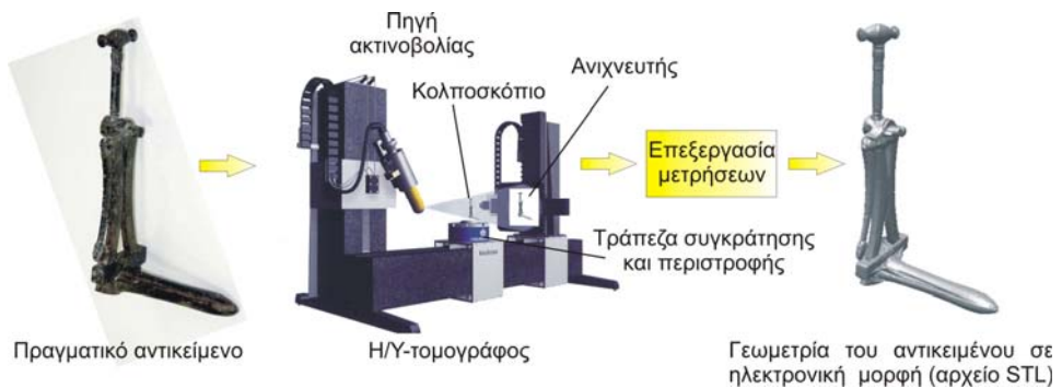
Σχήμα 2: Καταγραφή της γεωμετρίας σε ηλεκτρονική μορφή, με τη βοήθεια αξονικού τομογράφου, υποστηριζόμενου από ηλεκτρονικό υπολογιστή (Η/Υ).
